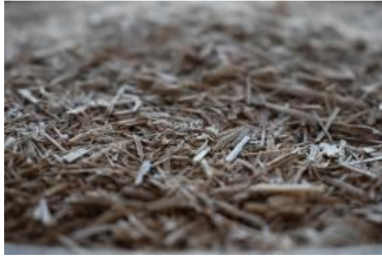
Figura 3. Cortadera reducida mecánicamente. Fuente: Elaboración propia (2021).
